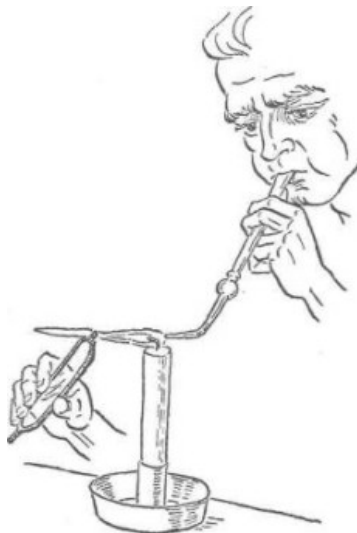
Figura 6. El soplete, introducido en el laboratorio por el químico sueco Cronstedt (1722-1765), fue un instrumento clave de análisis durante más de un siglo, y se utiliza todavía. El aire soplado por el tubo aumenta y dirige el calor de la llama.
